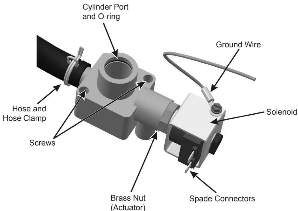
**Figure 35: Drain Valve**
