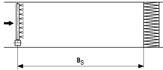
Fig. 33 : Installation dans la gaine de ventilation. Obstacle en aval : Filtre à particules
