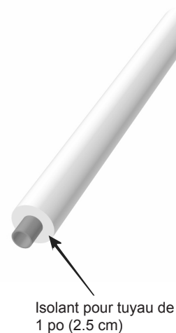
Figure 10: Exigences relatives au conduit de vapeur principale
