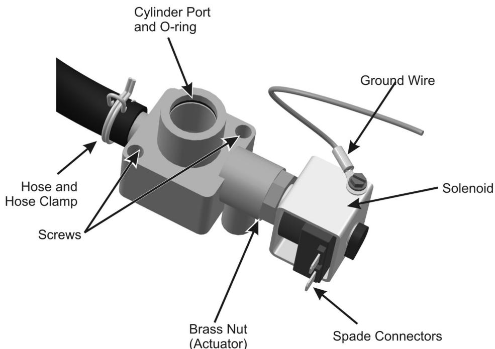
**Figure 35: Drain Valve**
