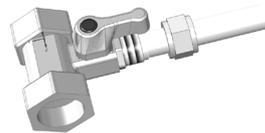
Utilisez un tuyau de 1/4" de longueur appropriée pour raccorder l'évacuation de l'OI à une évacuation d'eau correspondante. (La longueur maximale du flexible est de 16,4 in.)
