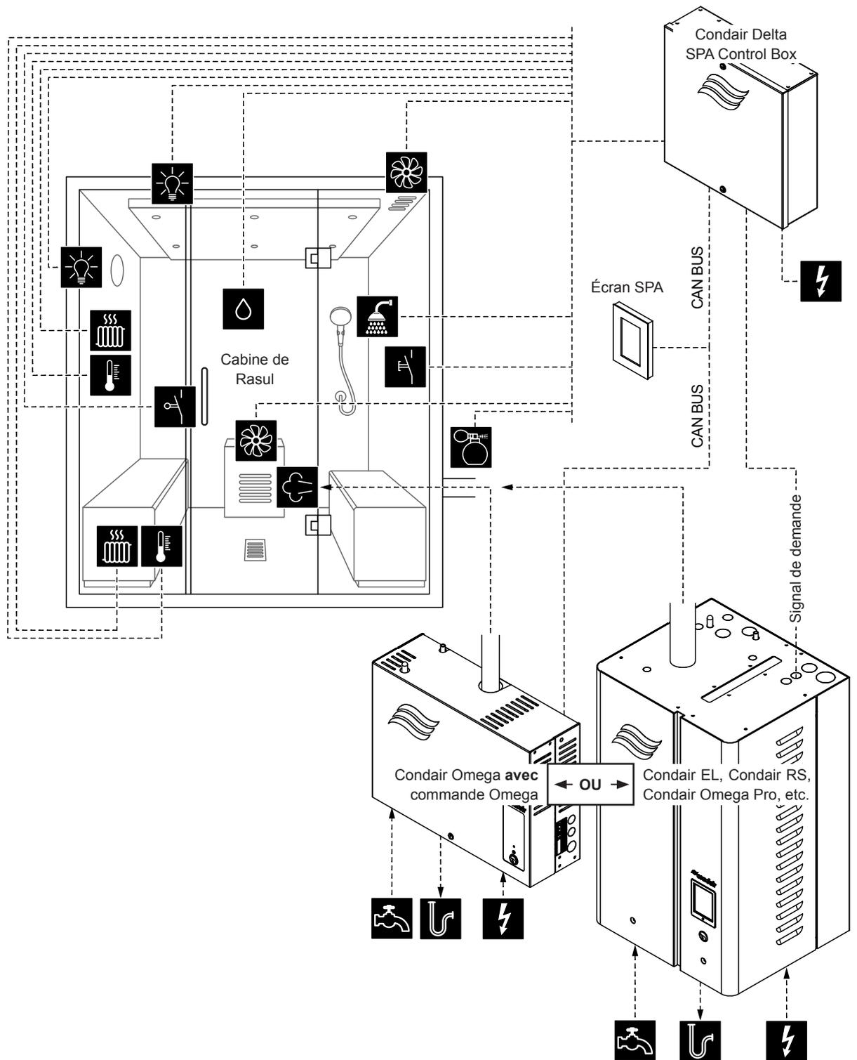
Fig. 6: Condair Delta SPA Control Box avec équipement pour Rasul
