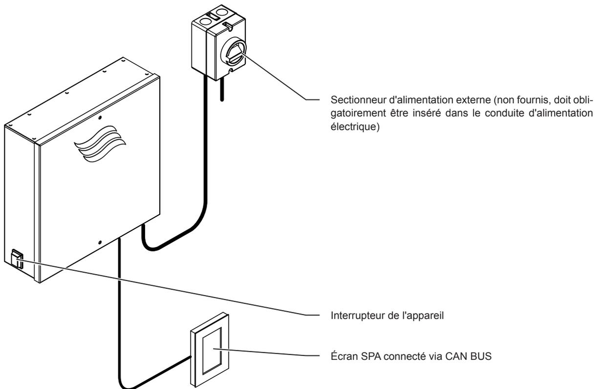
Fig. 2: Éléments d'affichage et de commande
