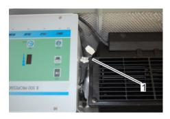
Fig. 52: Removing the fan plug
