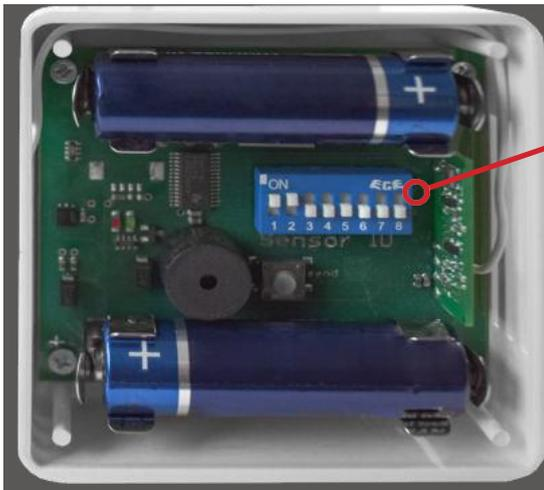
Fig. 5.6.4 : Codage de l'émetteur radio d'humidité
