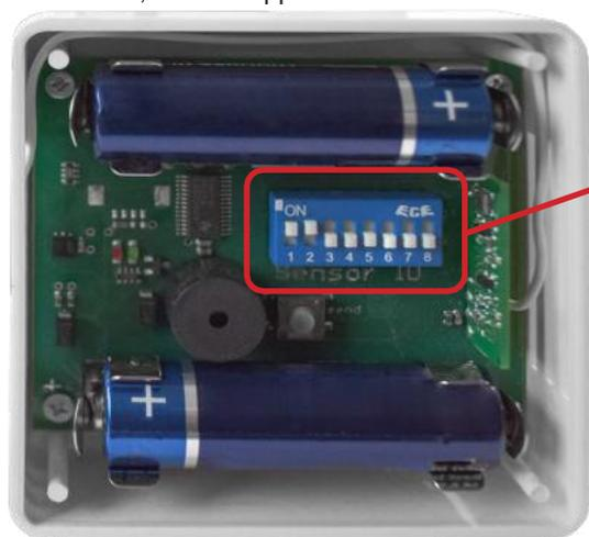
Fig. 5.6.1 : Vue intérieure de l'émetteur radio d'humidité
