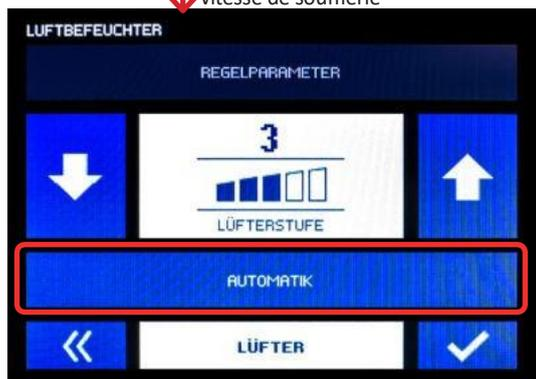
Fig. 5.5.2 : Réglage de la vitesse de soufflerie
