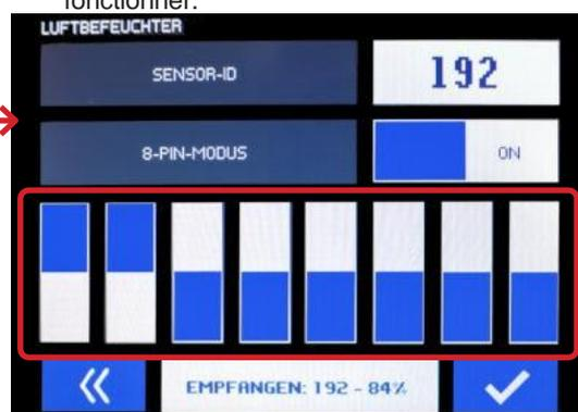
Fig. 5.6.7 : Codage de l'émetteur radio d'humidité
