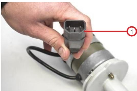
Fig. 7.4.1.7 : Desserrer la connexion du connecteur
