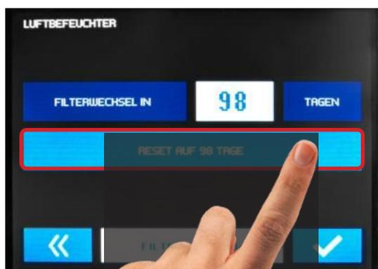
Fig. 6.3.2.7 : Réinitialiser l'affichage du changement de filtre
