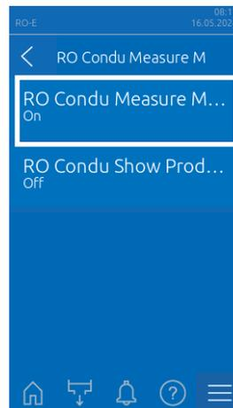
13. Aktivieren Sie die Leitfähigkeitsmessung (Schnellzugriff: 123) in der Steuersoftware gemäss den Abbildungen. (Dieser Parameter ist nur bei RO-E einstellbar.)
