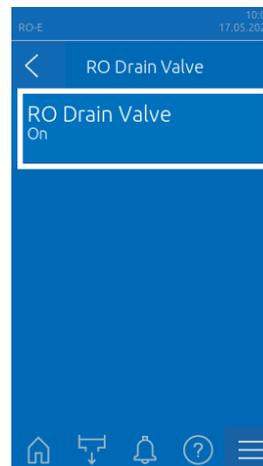
19. Aktivieren Sie das Entleerventil (Schnellzugriff: 104) in der Steuersoftware gemäss den Abbildungen. (Dieser Parameter ist nur bei RO-E einstellbar.)
