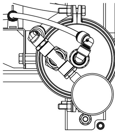
7. Schliessen Sie den Schlauch [1] wieder an der Steckkupplung [7] an. Prüfen Sie den Schlauch auf Beschädigungen und Abnutzung und ersetzen Sie ihn wenn nötig.
